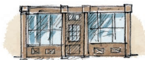
À partir du XIX e siècle, devanture en bois en saillie sur le mur en maçonnerie
