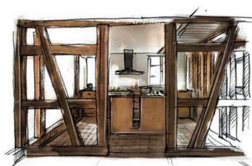
Le colombage ajouré offre des espaces ouverts et lumineux tout en conservant la structure porteuse du bâtiment.
