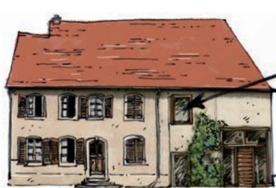
Création d'une nouvelle ouverture en saillie et transformation d'usage de la porte charretière.
